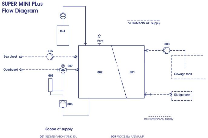
001 SEDIMENTATION TANK 30L 002 REACTION & DISCHARGE TANK 65L 003 TRANSFER PUMP 004 CHLORINE DOSING
